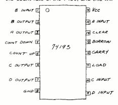
Fig. 4. 74193 pin diagram.
