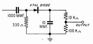
Fig. 3—Crystal Diode Detector
