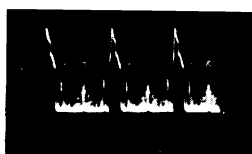
HORIZ. RATE 40V P-P V205A PIN 2 AGC GRID
