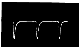
HORIZ. RATE 65V P-P V201B PIN 1 SYNC PLATE
