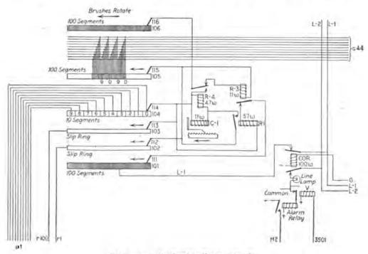
FIG. 139.-Decimal indicator circuit.
